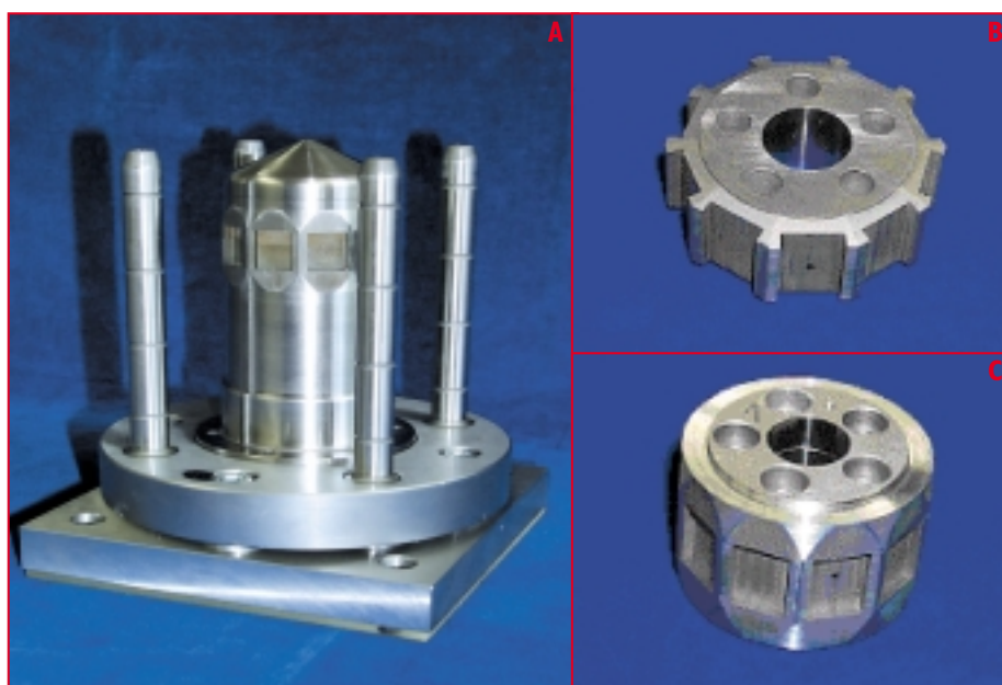
Abb.4: Langzeitkorrosionsapparatur: Auswerferseitige Werkzeughälfte mit Kern (A), Probenhalter (B), Probenhalter mit Übergangsrings (C), Probekörperbemaßung (D)
