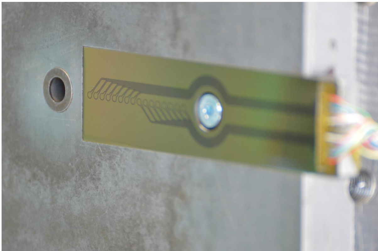
Abb. 5: Einbausituation des Sensormoduls mit 16 kreisförmigen Sensorstrukturen in das Spritzgusswerkzeug in nächster Nähe zur Düse.
